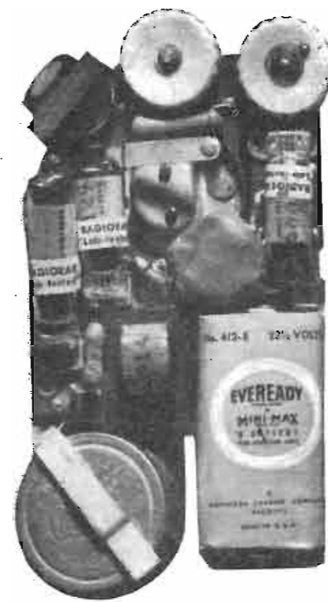
Fig. 2 - Aspetto interno di un amplificatore per sordi Radioear.
